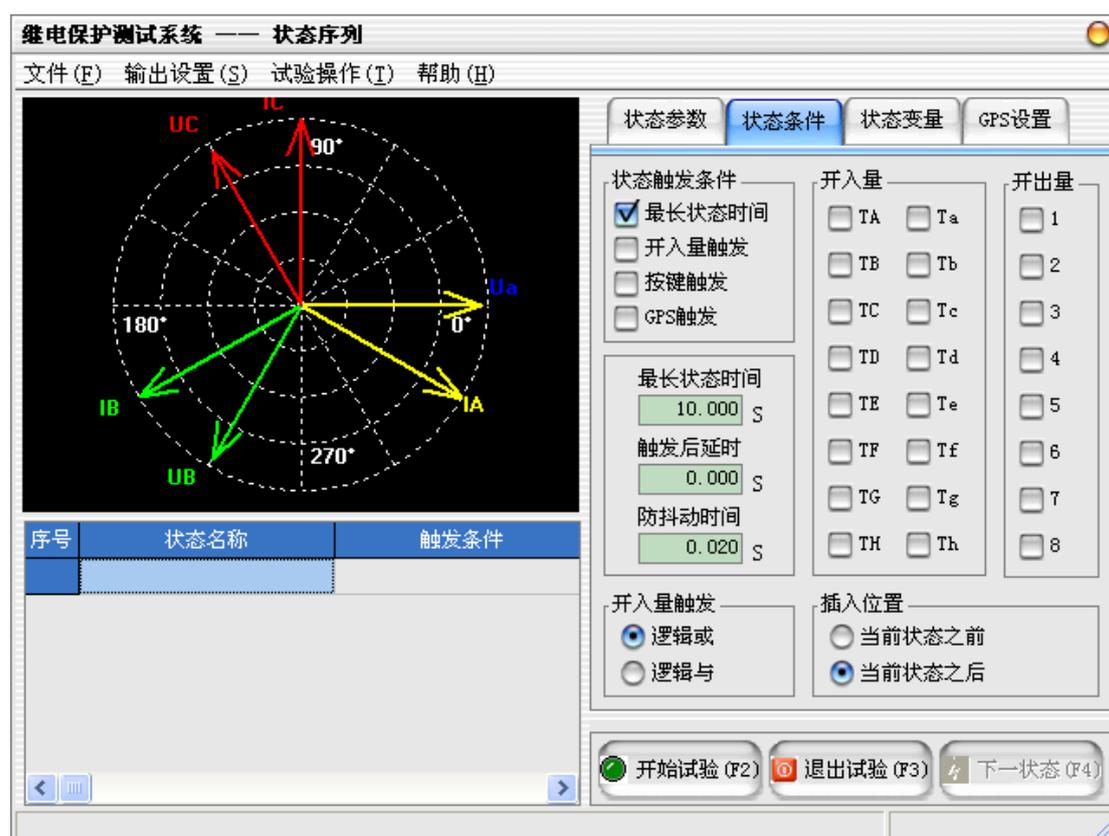
在“状态条件”属性页中设置当前状态的触发条件。最长状态时间和开入量触发可同时选择作为一种触发条件。两者为“或”的关系，只要其中一个条件满足，试验将进入到下一状态。在故障前状态最长状态时间的设定时，一般要大于保护装置的整组复归或重合闸的充电时间。当满足所设置的触发条件后，试验自动进入到下一状态。触发条件满足后，测试仪的对该状态的输出要在触发后延时结束后(设置了触发后延时时间)，方进入到下一试验状态。在“状态条件”属性页中还可以设置开入量、开出量和状态插入的位置。
