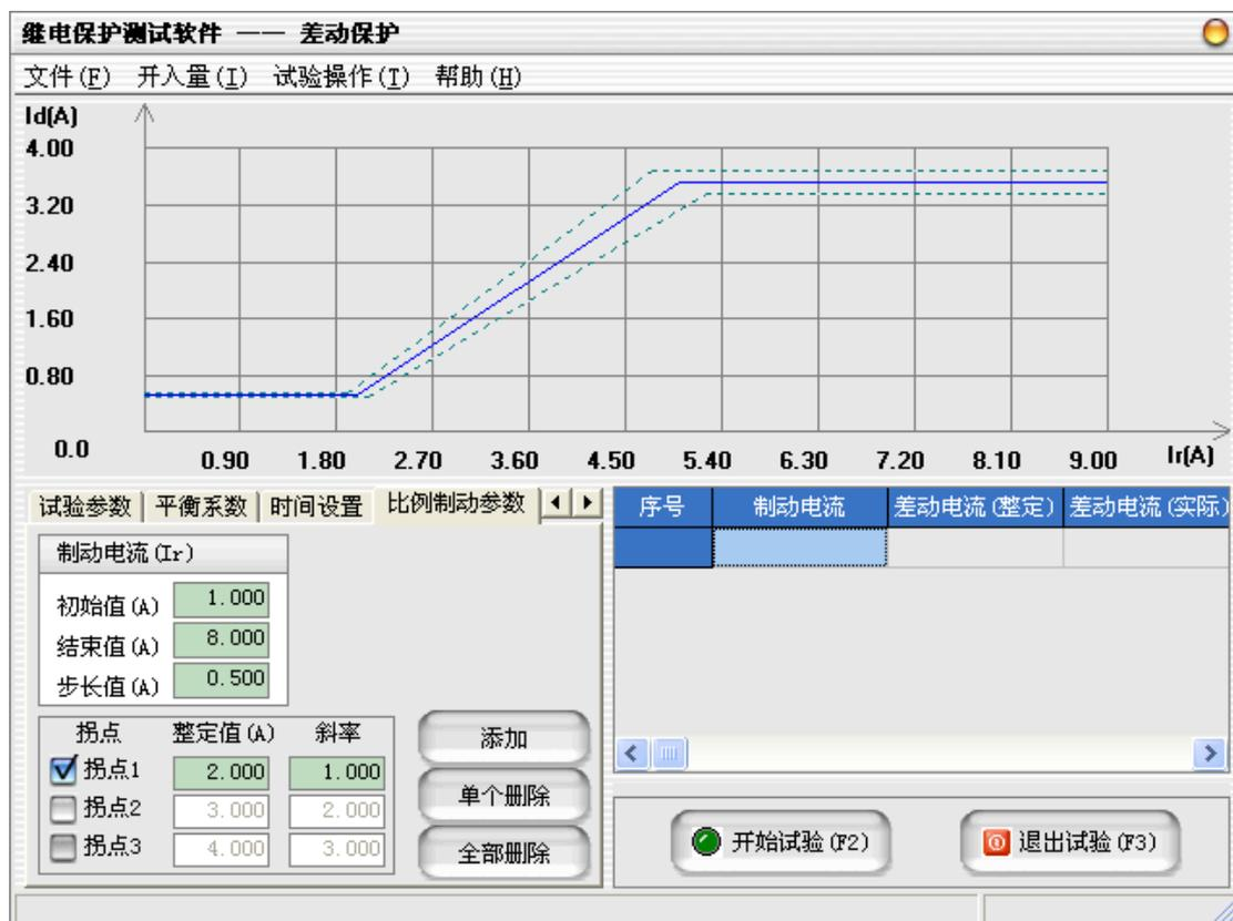
在“比例制动参数”属性页中设置比例制动特性的拐点和试验要测试的制
