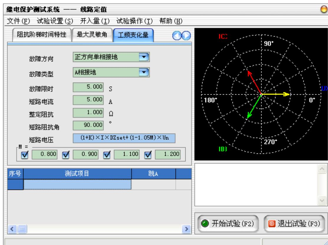
本试验用于对线路保护装置的工频变化量距离保护的定值进行校验。各子
